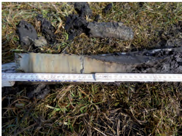
Bild 9: Bohrprobe am Probepunkt 05, abdichtende Bodenschicht in ca. 65 cm Tiefe
